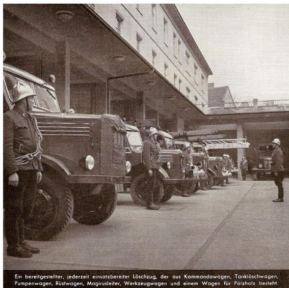
Ein bereitgestellter, jederzeit einsatzbereiter Löschzug, der aus Kommandowagen, Tanklöschwagen, Pumpenwagen, Rüstwagen, Magirusleiter, Werkzeugwagen und einem Wagen für Polzholz besteht.
